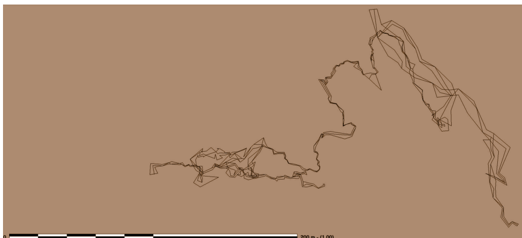
Plan d'une cavité après calcul et avant dessin (P 7, -624, Ariège, Flo Guillot)
