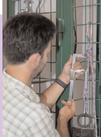
Mesure du glissement du brin libre d'un nœud de longe.
