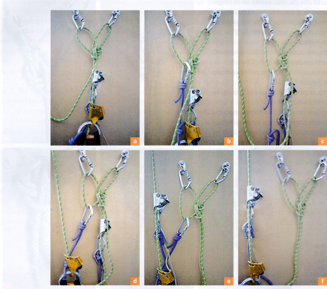
Figure 8 : Passage de fractionnement à la remontée, un des deux bloqueurs est toujours sur la corde.
