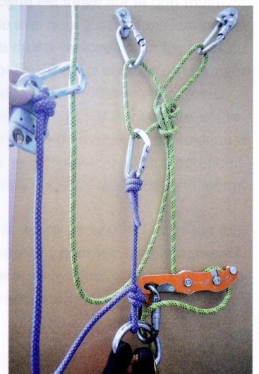
Figure 10 : Passage de fractionnement à la descente. Il est possible de se longer dans la boucle du fractionnement pour se contre-assurer pendant le passage du fractionnement.
