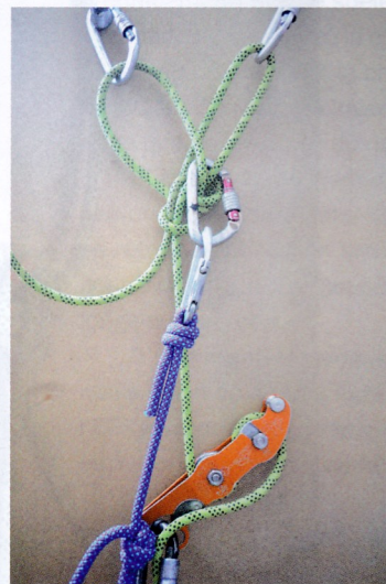
Figure 9 : Lorsque de nombreuses personnes sont amenées à passer il est possible d'ajouter un mousqueton de confort prenant les deux ganses du nœud.
