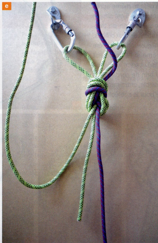
Figure 2: Nœud de huit double ou Mickey et tressage de corde pour rabourage avec triple huit.
