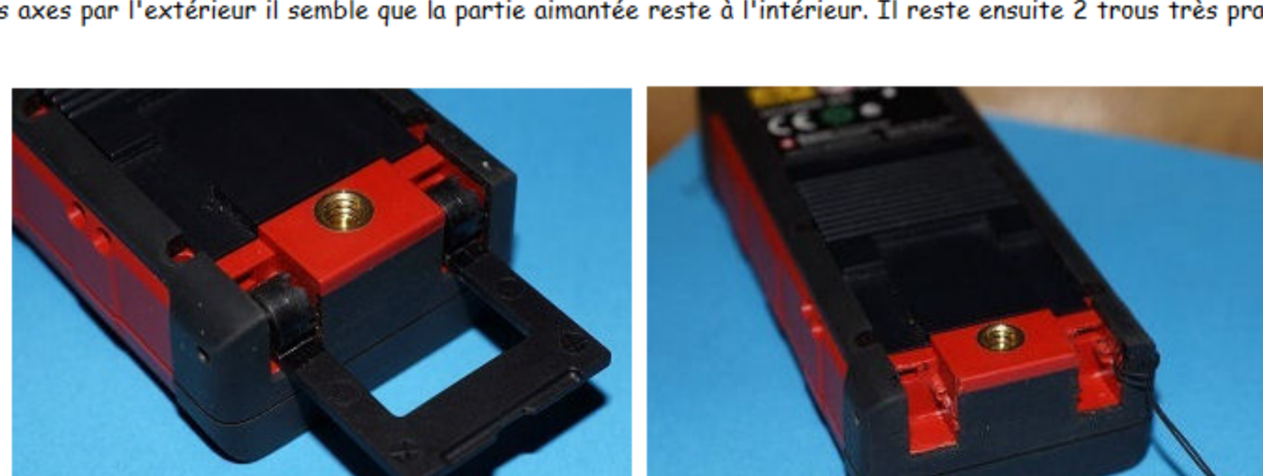
AVANT démontage de la pièce magnétique / APRÈS démontage et ajout d'une gageon
