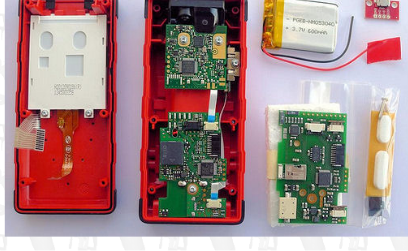
Doc. 5 Le disto ouvert en (deux parties à gauche) et la carte X2, l'accu LiPo et le connecteur (à droite)
